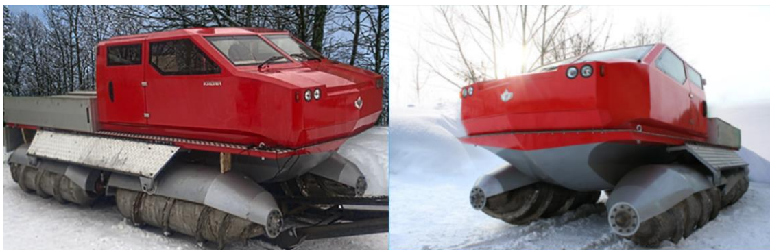
Рисунок 1 – Экспериментальный образец универсального спасательного средства
